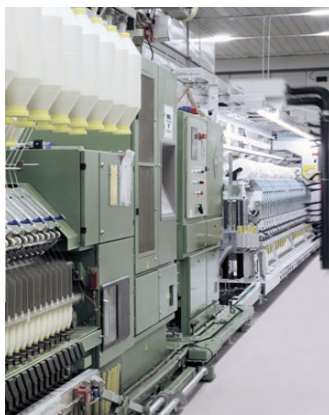
รูปที่ 4-13 เครื่องปั่นด้ายวงแหวน G32 Ring Spinning
