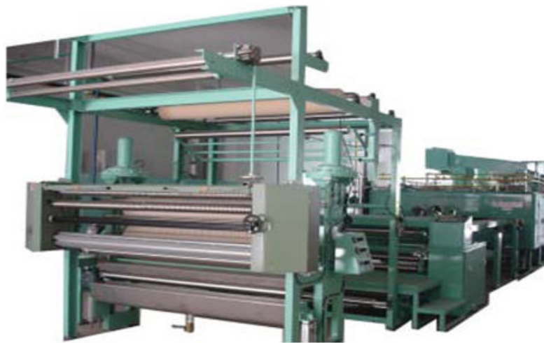
รูปที่ 4-4 เครื่องอบตกแต่งสำเร็จผ้าผืนประสิทธิภาพสูง Stenter
