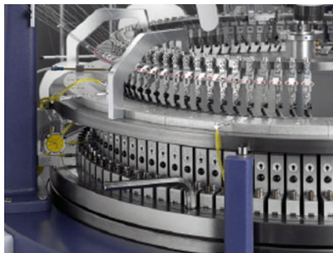
รูปที่ 4-14 เครื่องถักที่ประกอบด้วยเครื่อง HKS4 F terry
